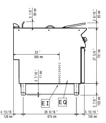
Electrical inlet (power) EQ Equipotential screw
